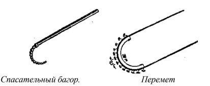
**Перемет** служит для поиска утонувшего. Он представляет собой конец длиной 40 *м*, диаметром 25 *мм* с подвешенными к нему маленькими четырехлапыми кошками. Трос на протяжении 10 *м* с обоих концов свободный, а на средних 20 метрах имеет укрепленные кошки в 0,5 *м* друг от друга.
